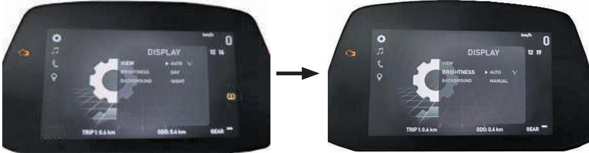
Avec « ✓ » pour l'état actuellement sélectionné, appuyez sur ▼ ou ▲ sur le mode correspondant, appuyez sur la touche SET pour confirmer l'état sélectionné, et appuyez sur BACK pour revenir. Lorsque le mode manuel est sélectionné, appuyez sur la touche SET pendant quelques secondes, une barre de réglage « 75% - [ ] + » s'affiche, appuyez sur « ▲(+) » ou « ▼(-) » pour régler la luminosité.
