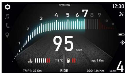
Après avoir sélectionné TRIP, appuyez sur la touche ▼, **RIDE** devient l'icône à sélectionner et à mettre en surbrillance.
